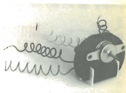
Struttura di motore racchiusa fra i lamierini ferromagnetici.
