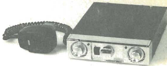
Le caratteristiche generali del preamplificatore sono coerenti ai dati di ingresso microfonici della maggioranza dei ricetrasmittitori. Nell'immagine il Catalina della SBE.
