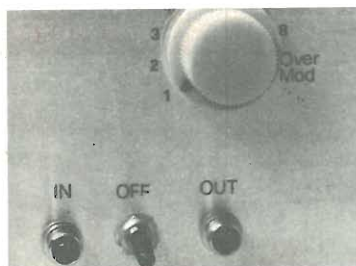
Particolare del pannello frontale dell'apparecchio. In alto, comando per la regolazione del guadagno; in basso, ingresso, interruttore ed uscita amplificata.
